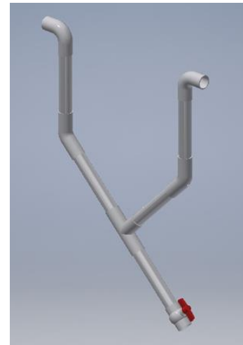
Fig. 5. Configuración recomendada para la trampa de condensados.
