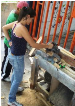
Aserrado de paneles contrachapados para obtener piezas, con la ayuda de carpinteros.
