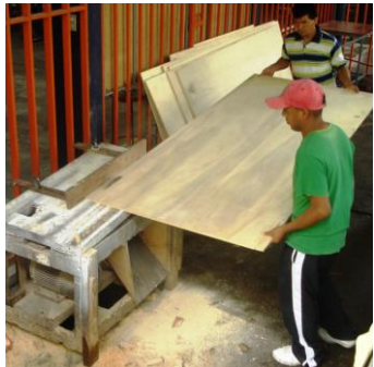
Aserrado de paneles contrachapados para obtener piezas, con la ayuda de carpinteros.
