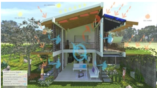
Sección volumétrica, criterios bioclimáticos
