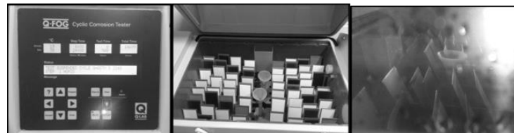
Fig. 5 Ciclo de 500h dentro de la Cámara de Intemperismo Acelerado (QFOG).
