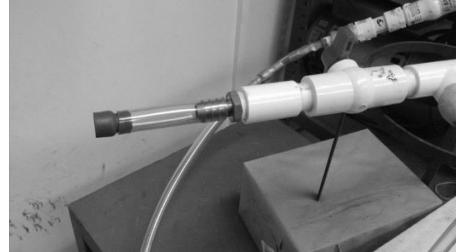
Fig. 11 Ajuste hecho al sistema para la extracción de muestras con el objetivo de medir la calidad del biogás.
