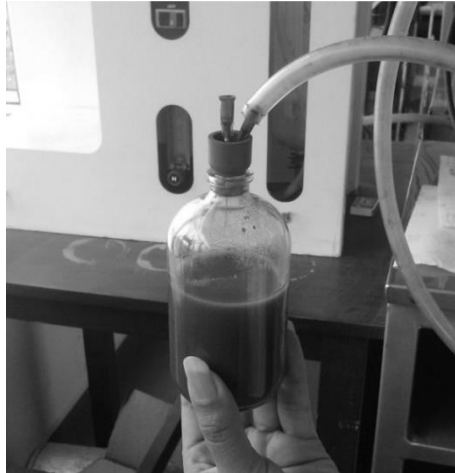
Fig. 10 Procedimiento para purgar los gases en cada bote de prueba BMP.
