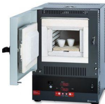
Fig.7.47 Colocación del suelo en la mufla a 440°C. Fuente: Elaboración propia.
