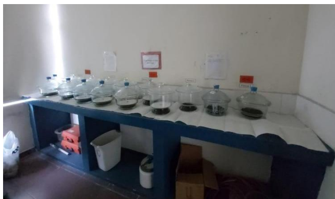
Fig.7.50 Sistema de biodegradación armado. Fuente: Elaboración propia.
