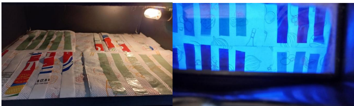
Figura 7.64 Disposición de las muestras en la cámara UV (izquierda), muestras sometidas a radiación ultravioleta (derecha)
