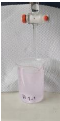
Fig.7.56 Titulación de la muestra 1 con HCl. Fuente: Elaboración propia.
