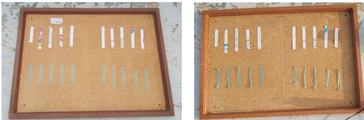
Figura 7.65 Inicio de la prueba de exposición solar (izquierda) final de la prueba de exposición solar (derecha).
