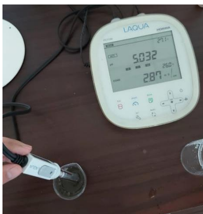
Fig.7.48 Medición de pH del suelo. Fuente: Elaboración propia.
