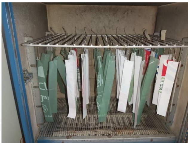
Figura 7.63 Disposición de muestras en proceso de oxidación térmica a 45 °C.
