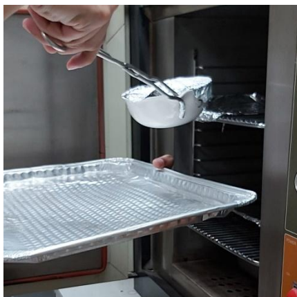
Fig.7.46 Secado del suelo en horno a 105°C. Fuente: Elaboración propia.
