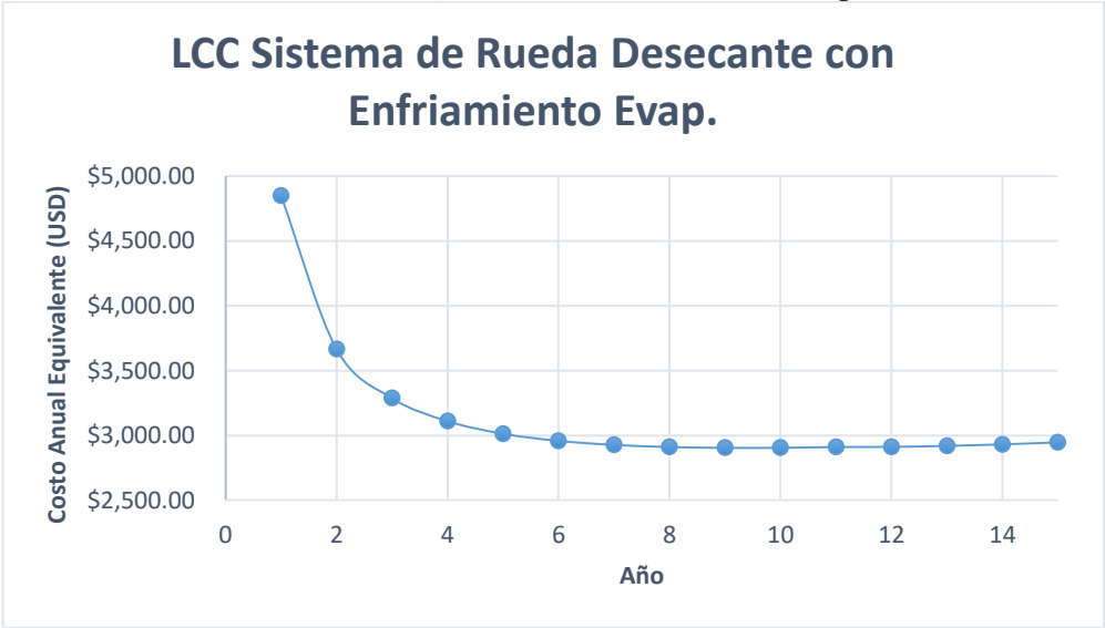
Ilustración 30 Análisis del costo de ciclo de vida del sistema de rueda desecante con enfriamiento evaporativo
