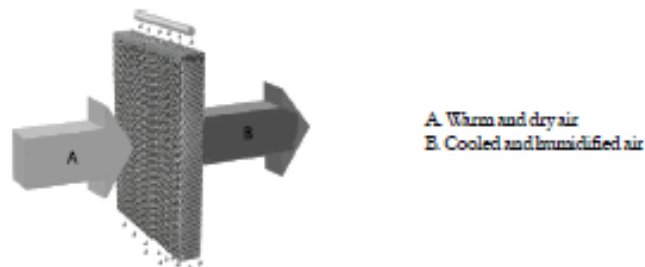
Ilustración 37 Principio de funcionamiento del enfriador
