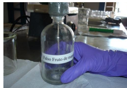
Fig. 1 Introducción de 80 ml de lodos anaerobios en la botella de 160 ml.
