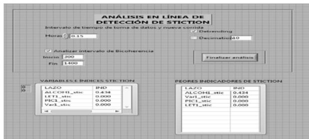
Fig.13 Resultado de detección de stiction de herramienta en línea.
