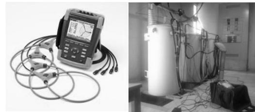
Fig. 7 Fluke 435 serie II, analizador de energía.
