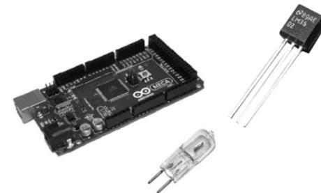
Fig.1 Principales elementos utilizados en la planta del modelo de control de temperatura; ARDUINO mega 2560, lámpara 12 V (tipo lagrima), sensor LM35.
