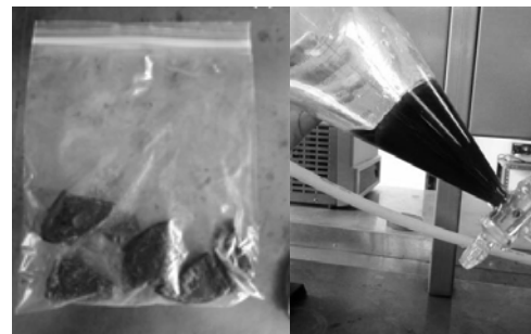
Fig. 7 Solidificación de la glicerina en los ensayos 1 y 2.
