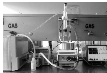
Fig. 6 Montaje del reactor para la transesterificación alcalina homogénea.
