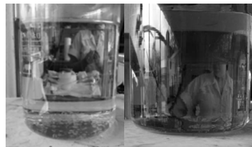
Fig. 10 De izquierda a derecha: biodiesel después de una etapa de secado y biodiesel después de dos etapas de secado.
