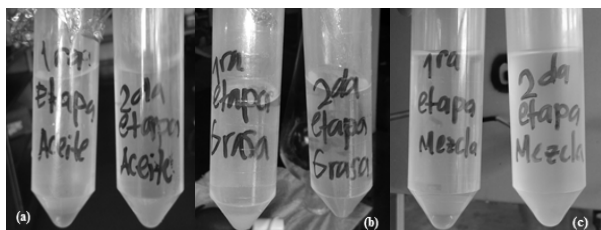
Fig. 12 Prueba 3/27. (a) Aceite usado, (b) Grasa de pollo y (c) Mezcla 40/60.
