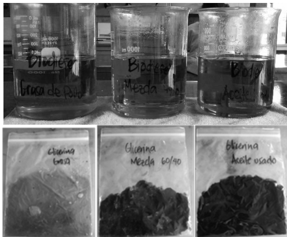
Fig. 11 Biodiesel producidos secos y glicerina cruda, de izquierda a derecha: grasa de pollo, mezcla 40/60 y aceite usado.
