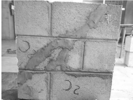
Fig. 5 Prisma de compresión diagonal reparado.
