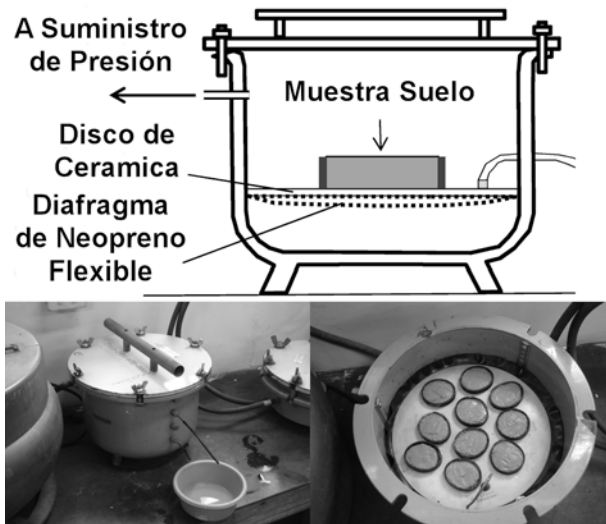
Fig. 3 Esquema de olla de presión y fotos de laboratorio (Chavez et al. 2013).
