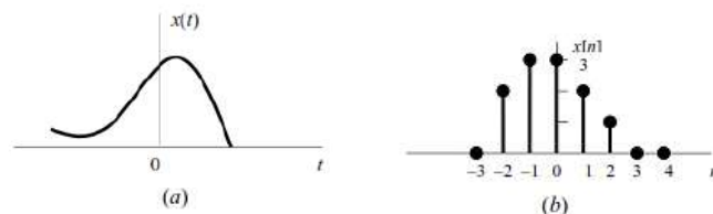
Figura 1. Señales de tiempo continuo y tiempo discreto
