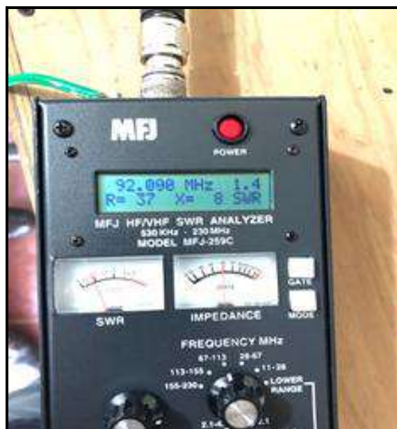
Fig. 6. Analizador MFJ-259C midiendo SWR
