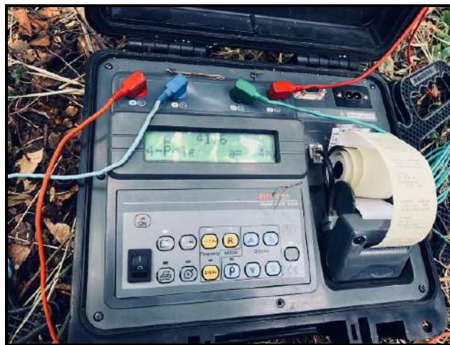
Fig. 5. Medición de resistividad del suelo
