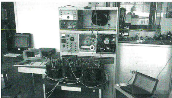
Fig. 3 Montaje de equipo y medidores para realizar las pruebas de variación de frecuencia y carga.
