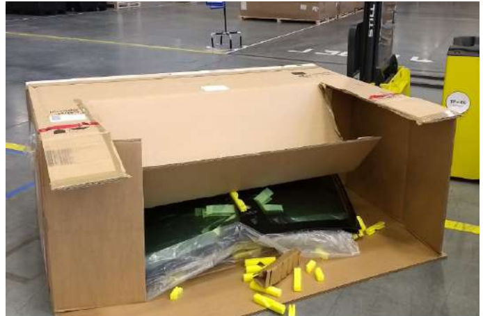
Fig. 4. Queda da caixa
