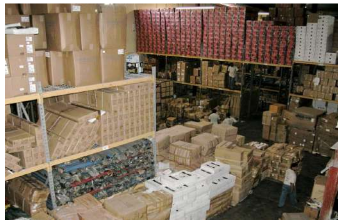
Fig. 5 Almacenamiento defectuoso con ancho de pasillo insuficiente. Fuente: elaboración propia
