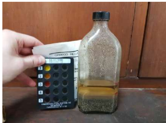
Fig. 5. Color de la solución de hidróxido de sodio en ensayo de impurezas orgánicas.
