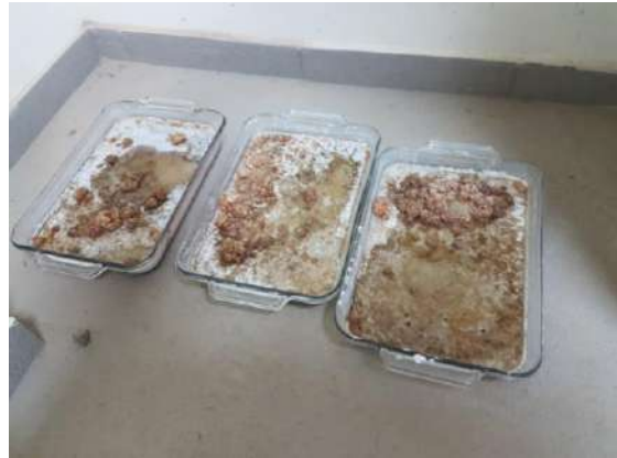
Fig. 4. Muestras de lodo secadas a 110 °C durante 60 horas y dejadas al aire libre posteriormente.
