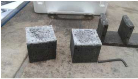
Fig. 8. Eflorescencia desarrollada por especímenes con relación molar Si:Al de 2.
