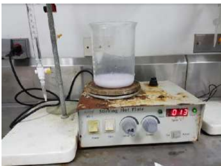
Fig. 2. Sistema de titulación empleado en la planta.
