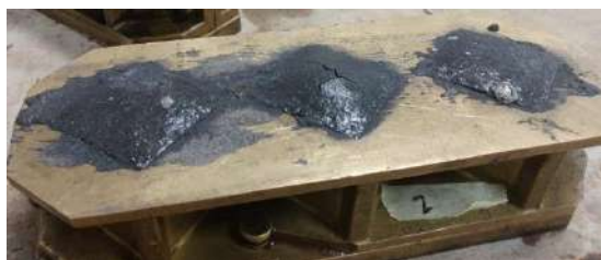
Fig. 7. Expansión hacia arriba de los especímenes secados a 80 °C.
