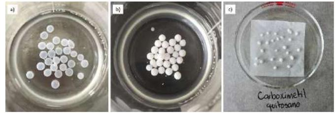
Fig. 7. Hidrogeles de carboximetil quitosano a) recién formados, b) reposados por 30 minutos, c) luego del proceso de lavado.
