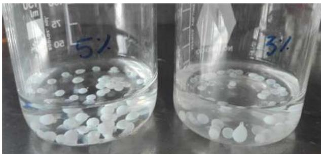
Fig. 6. Hidrogeles de carboximetil quitosano con soluciones al 3% y 5%.
