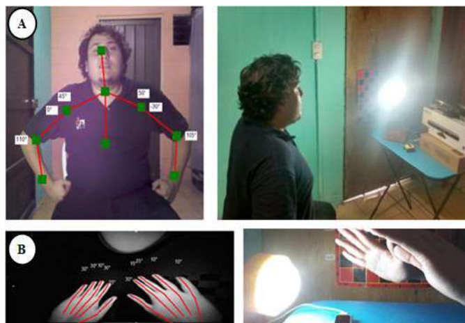
Fig. 23. Iluminación excesiva frente a: a) sensor Kinect y b) sensor Leap Motion.
