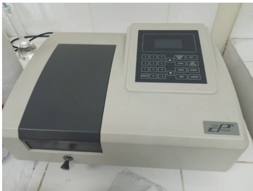
Figura B4. Espectrofotómetro Cole Parmer UV-Vis para la determinación colorimétrica de fósforo por método de ácido tartárico
